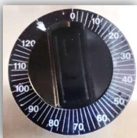
El equipo dispone de temporizador para controlar los tiempos de funcionamiento del equipo, pudiéndose controlar de 1 minuto a 120 minutos máximo, en caso de más tiempo de funcionamiento se deberá de volver a programar.
